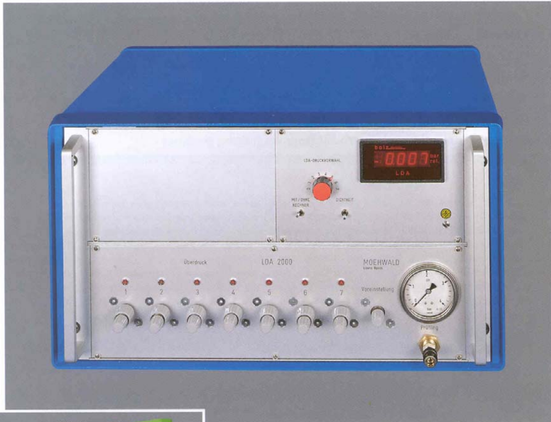
Gerät zur Ladedruckaufschaltung als Sonderversion mit 7 Überdruckkanälen
